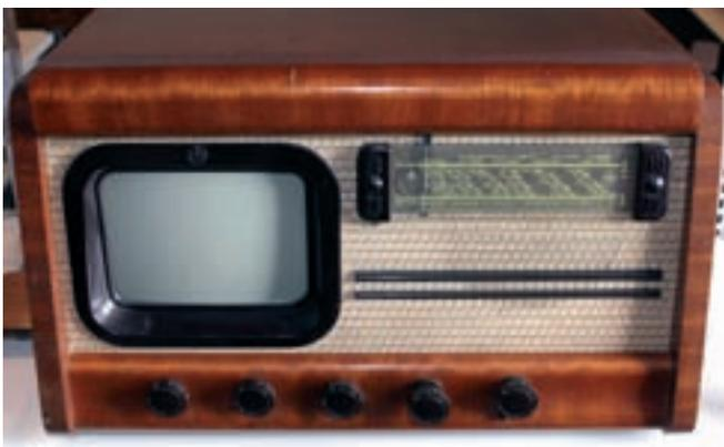
**Tesla Fernsehgerät 4002 mit Radio und „Magischem Auge“. Baujahr 1956, 220 V, 60 Hertz! Frage von Rudolf Mayer: Welches Land verwendete damals 60 Hz-Netzfrequenz? Kein Tuner (nur ZF-Verstärker) im Gerät vorgesehen**
