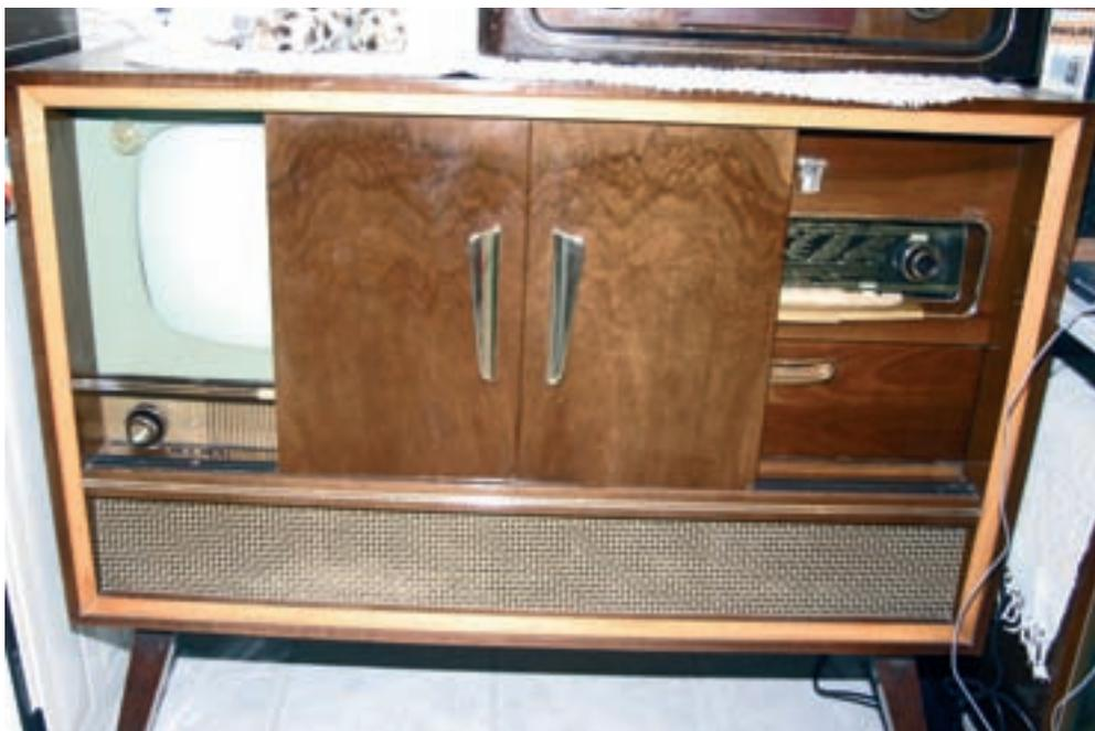
**Kapsch Radio-Phono-Fernsehschrank Modell SFS 58/43. Saison 1957/58. TV mit 43 cm/90 Grad-BR. VHF 12-Kanal-Wähler, Radio UKW-Mono. Unter dem Radio in der Klappe ein Dual 295 Plattenspieler. Dieses Modell gab es auch mit 53 cm BR, wurde immer weiterentwickelt, später mit UHF, Stereo-Phonoteil, Stereo-Radio mit Nachhalleinrichtung. Ein Allroundschrank für die Prominenz...**
